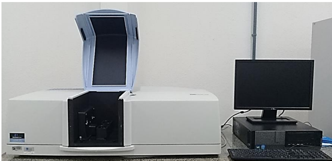
Figura 2.13: Espectrofotômetro Perkin – Elmer Lambda 1050.
