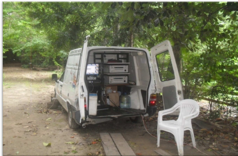
Figura 10 – Laboratório móvel de poluição do Instituto de Ciências Atmosféricas em funcionamento na área de estudo, IBAMA-AL, 2011
