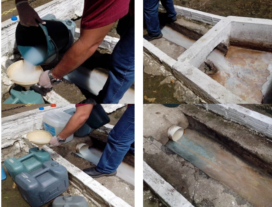
FIGURA 09 – Ponto de saída dos efluentes da linha de produção (ponto de coleta do efluente).
