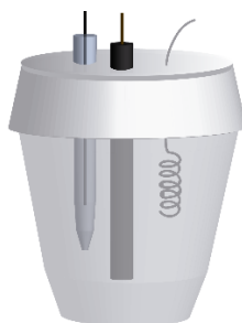
Figura 8 – Representação esquemática de cela eletroquímica de três eletrodos.
