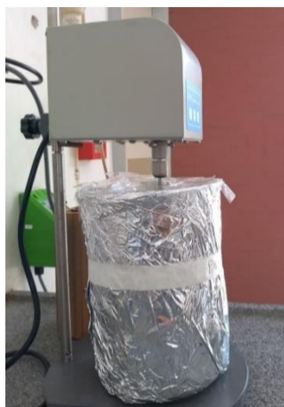
Figura 6 - Béquer utilizado como componente principal do reator.
