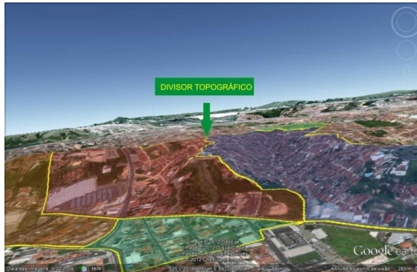
Figura 4.8. Exemplo de divisor topográfico utilizado na discretização Fonte: Adaptado de Google Earth
