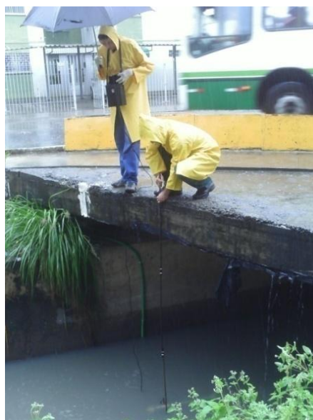
Figura 4.16. Medição de vazão com o molinete
