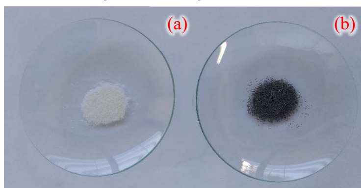
Figura 12 – Materiais obtidos pelo método de co-precipitação para síntese do HDL. (a) MgAl/HDL; (b) MgAl/HDL-biocarvão
