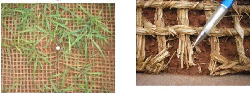
Fig.6 Geotêxteis de fibra de tronco de bananeira.
