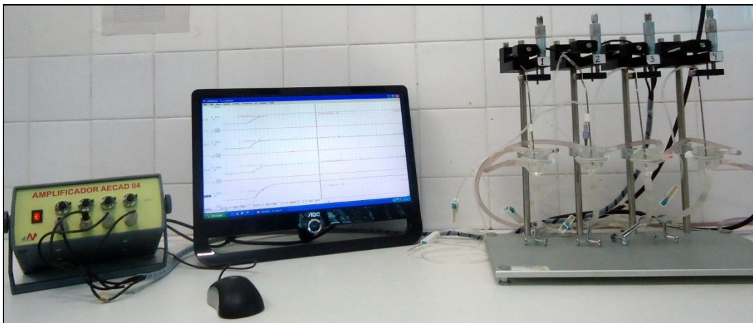
Figura 2 - Sistema de cubas e aquisição de dados de tensão isométrica para artéria mesentérica.
