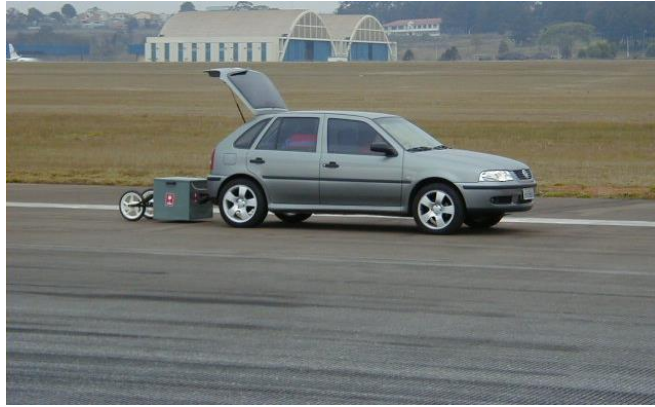
FIG. 15 - Exemplo de Levantamento em GPR. (Fonte: Site Dynatest)
