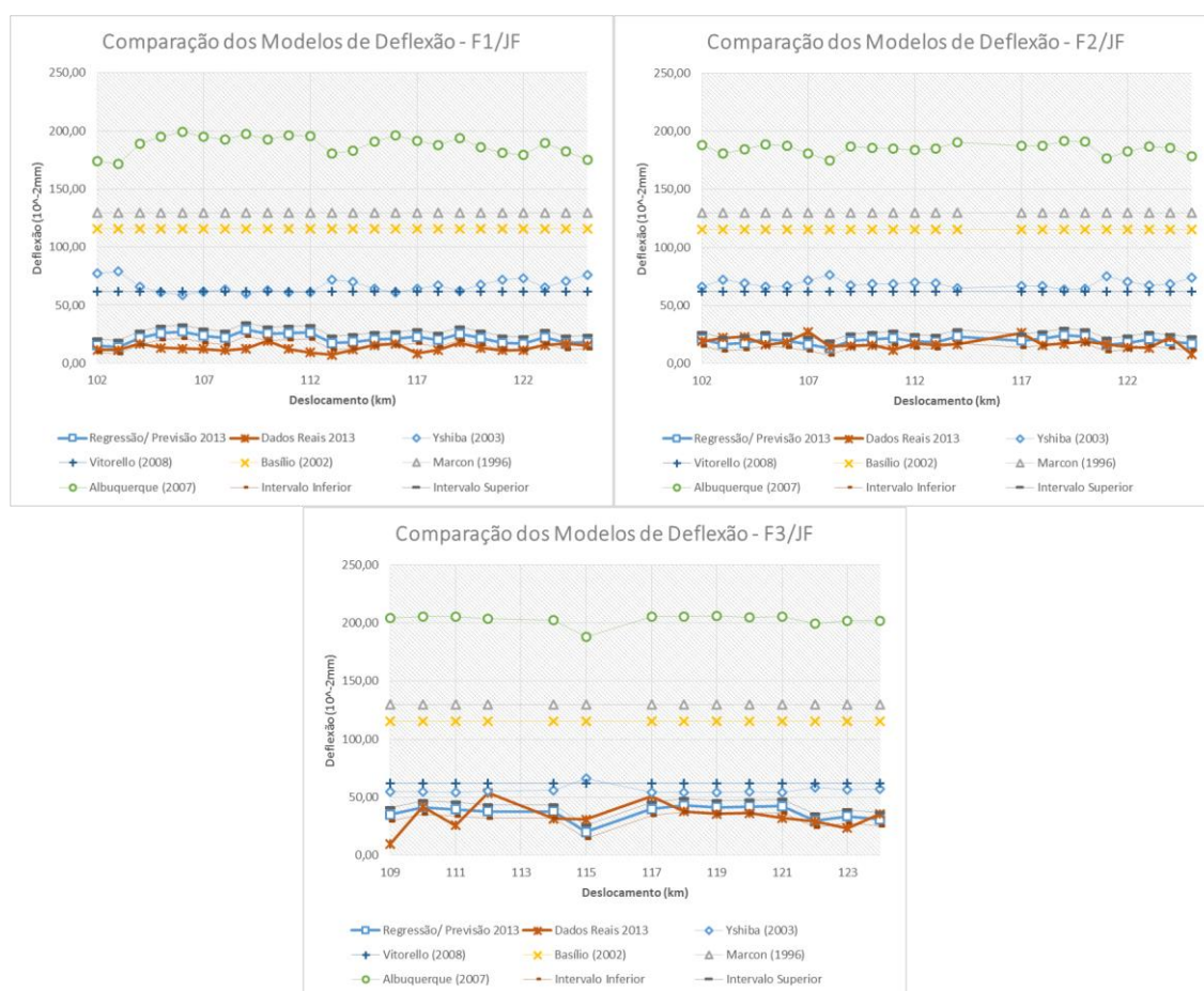
FIG. 38 - Comparação dos modelos previsão de deflexão sentido JF.
