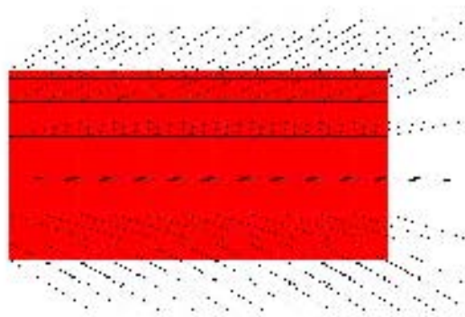
Figura 3.15 – Configuração deformada associada a modo de deformação constante \bar{\gamma}_{Xz} .
