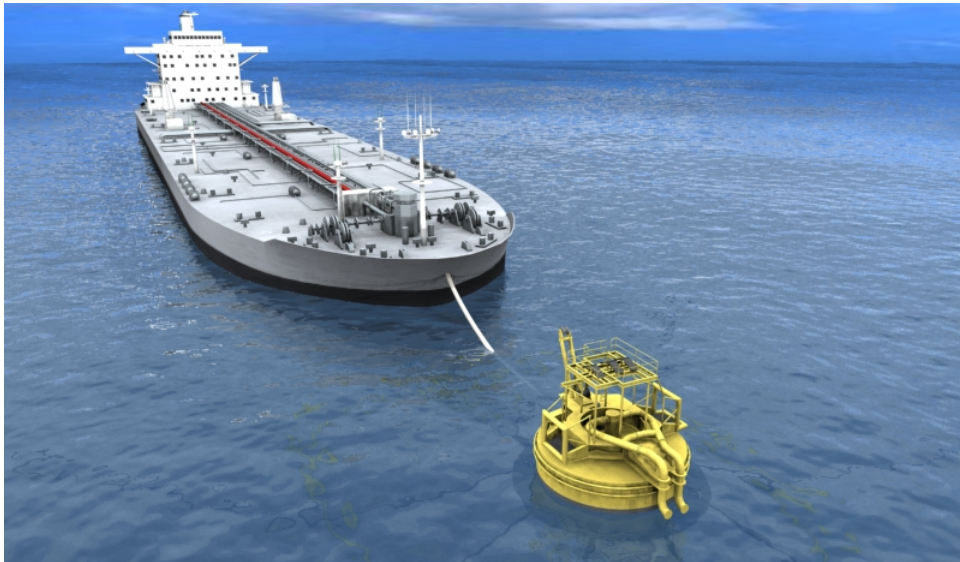
(b) Detalhe da operação de offloading
