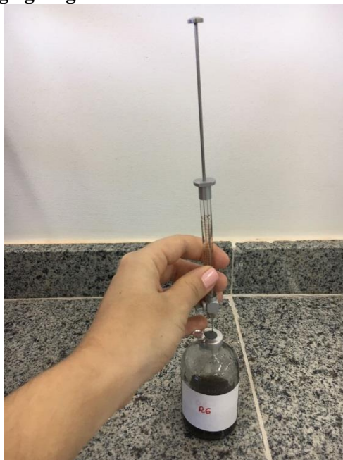
Figura 11– Retiradas amostras de 250uL da fase gasosa do headspace do reator com o uso de seringa gastigh com trava da marca Hamilton
