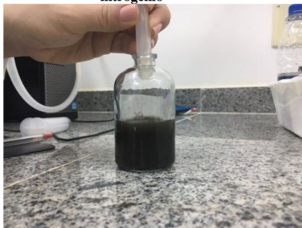
Figura 9 - Substituição de todo o ar atmosférico presente no headspace dos frascos pelo nitrogênio
