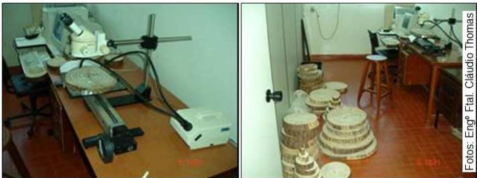
**Figura 36 - Medição de anéis de crescimento com LINTAB (hardware) + TSAP (software).**
