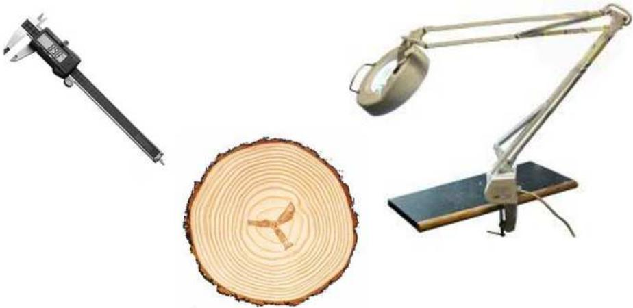
**Figura 35 - Medição de anéis de crescimento com lupa articulada e paquímetro.**
