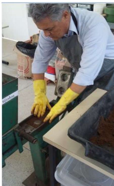
Figura 33 – Teste dos tijolos provisórios na máquina
