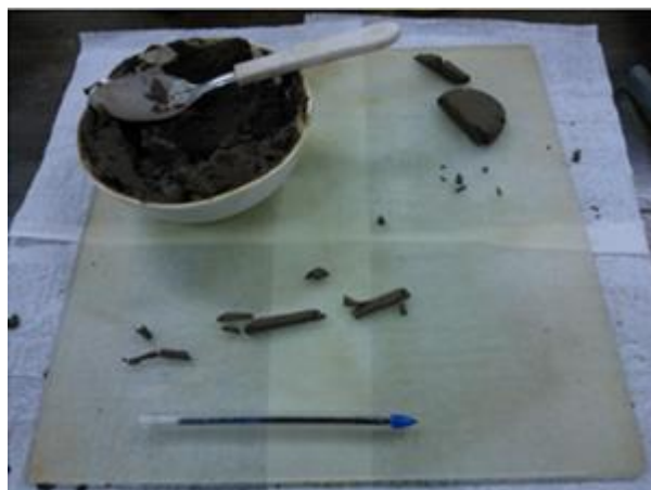
Figura 43 - Amostra de solo em forma de cilindro fragmentada antes de atingir os 3 mm de espessura
