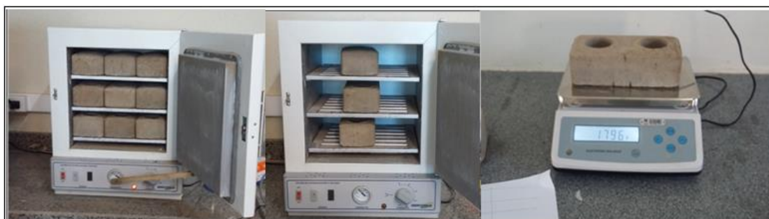
Figura 37 – Tijolos colocados na estufa; aferição da massa seca
