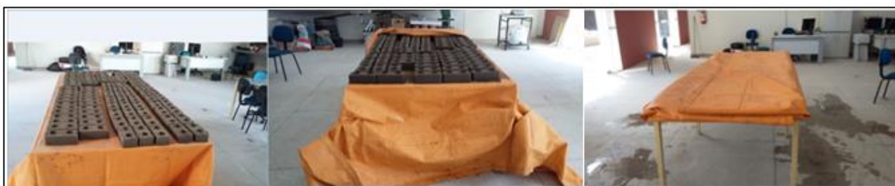
Figura 36 – Tijolos acomodados à mesa; câmara úmida improvisada para cura
