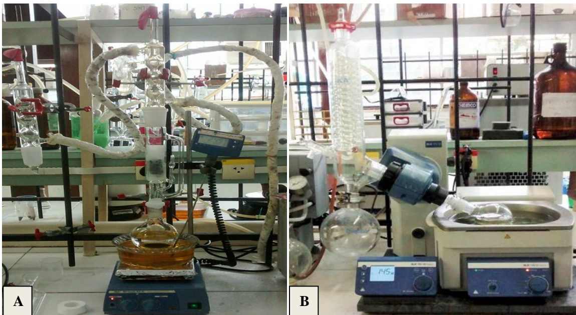
Figura 4 – Sistema extrator Soxhlet (A) e evaporador rotativo (B).
