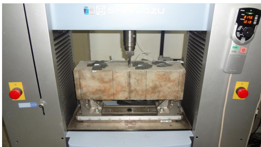
Figura 19 – Ilustração do equipamento Autograph AG-X, Shimadzu com Kit de testes N o . 346-53888-XX e corpo de prova para ensaio.
