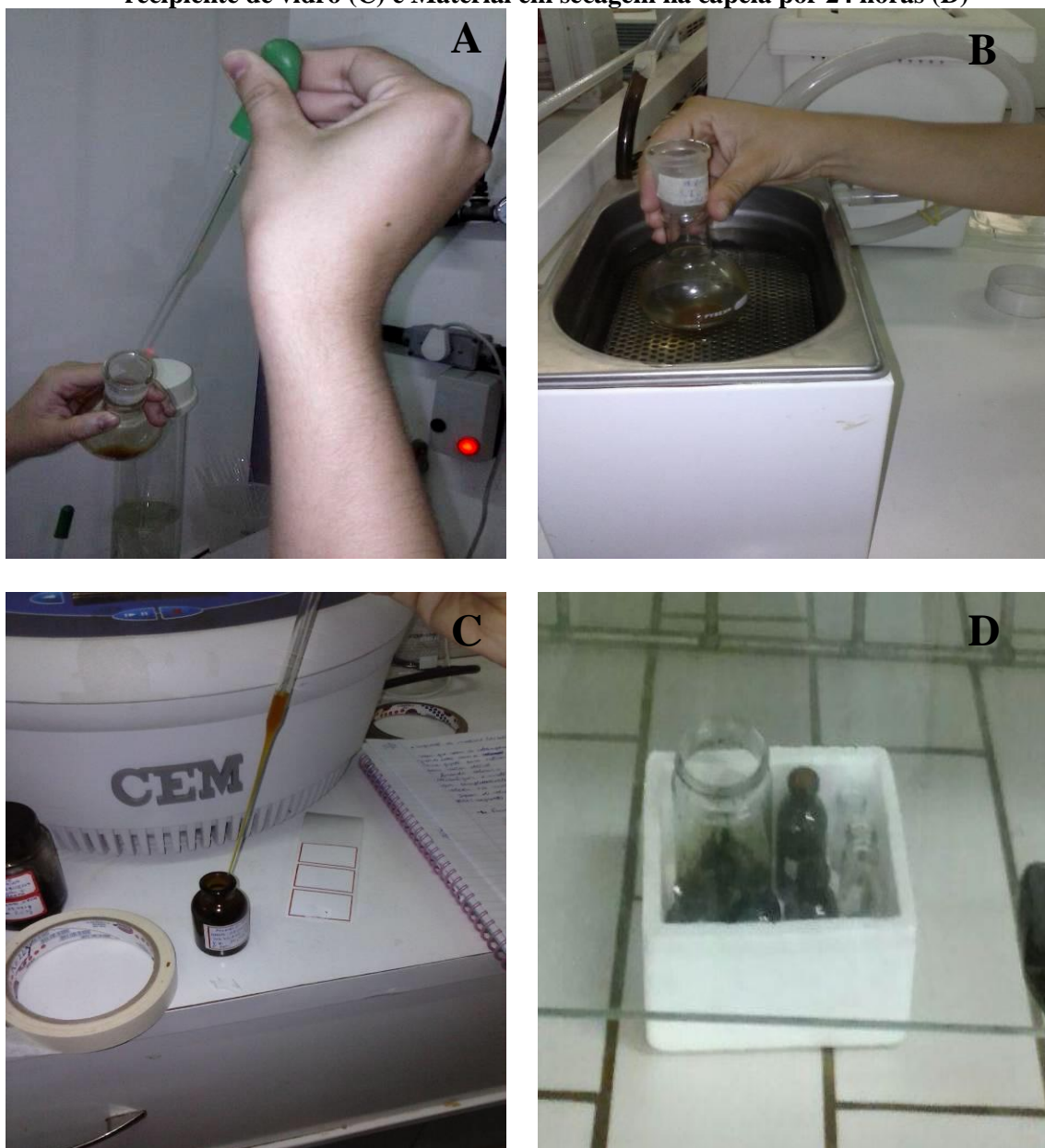
Figura 8 - Adição do solvente (Etanol PA) no material rotaevaporado (A), Material sendo solubilizado no ultrasson (B), Transferência do material solubilizado para recipiente de vidro (C) e Material em secagem na capela por 24 horas (D)
