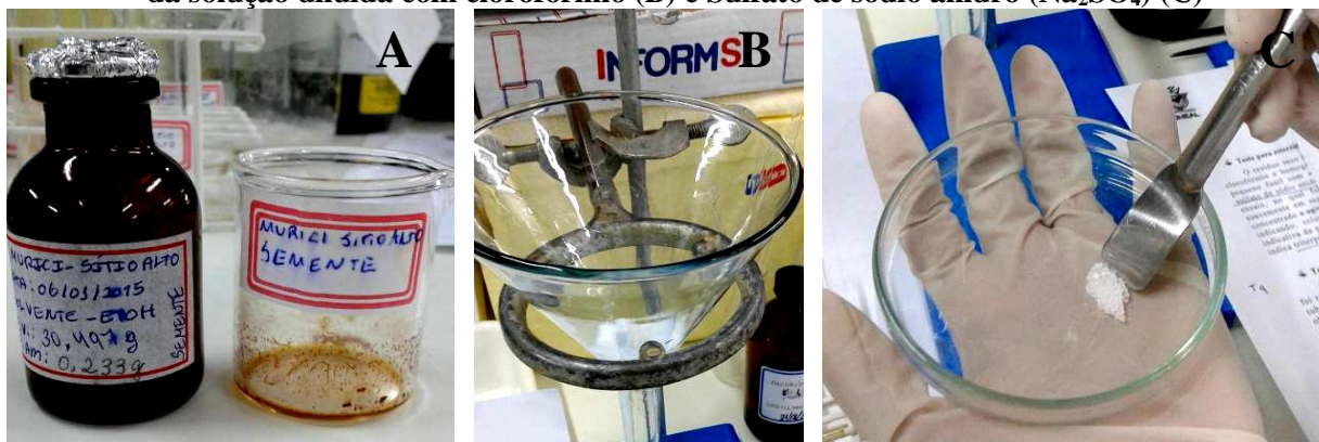
Figura 11 - Amostra após secagem na placa aquecedora (A), Funil com algodão para filtração da solução diluída com clorofórmio (B) e Sulfato de sódio anidro ( \text{Na}_2\text{SO}_4 ) (C)
