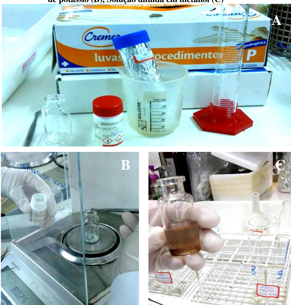
Figura 13 - Preparação para a solução de ABTS (A), Pesagem do persulfato de potássio (B), Solução diluída em metanol (C)
