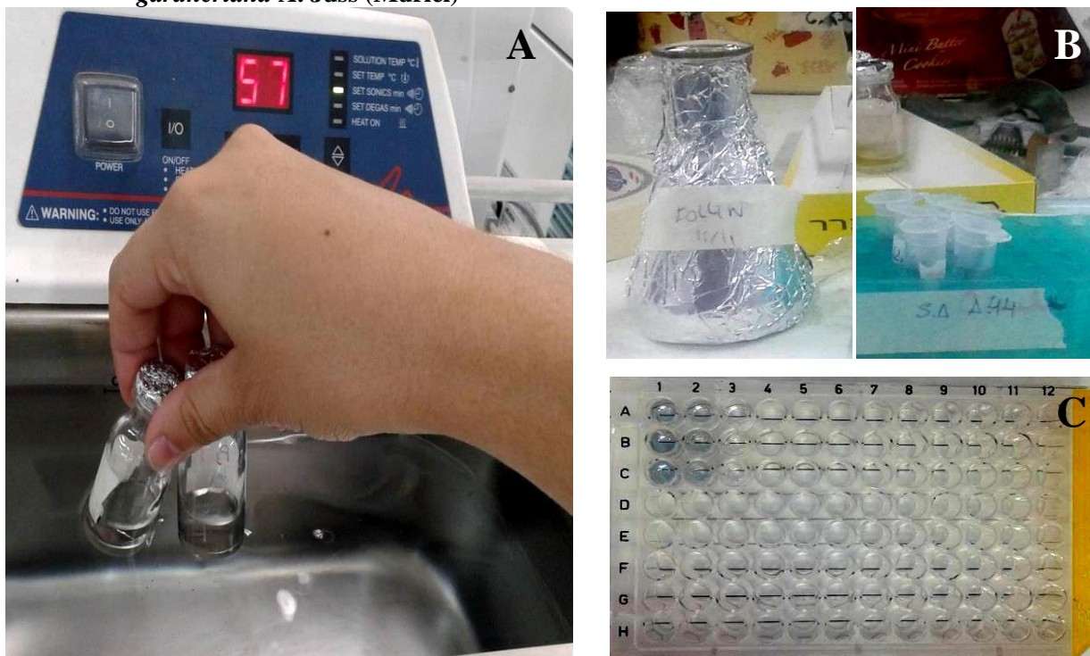
Figura 12 - Material sendo solubilizado no ultrasson (A), amostras das sementes em triplicata nos ependorfs (B) e microplaca com amostras em triplicata (C) da espécie Byrsonima gardneriana A. Juss (Murici)
