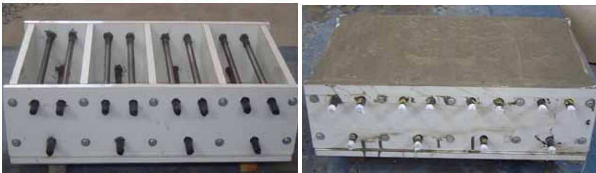
Figura 5.8. Formas para os prismas antes, à esquerda e depois da concretagem, à direita.
