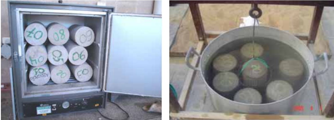
Figura 5.10. Corpos de prova na estufa, à esquerda e submersos para pesagem, à direita.
