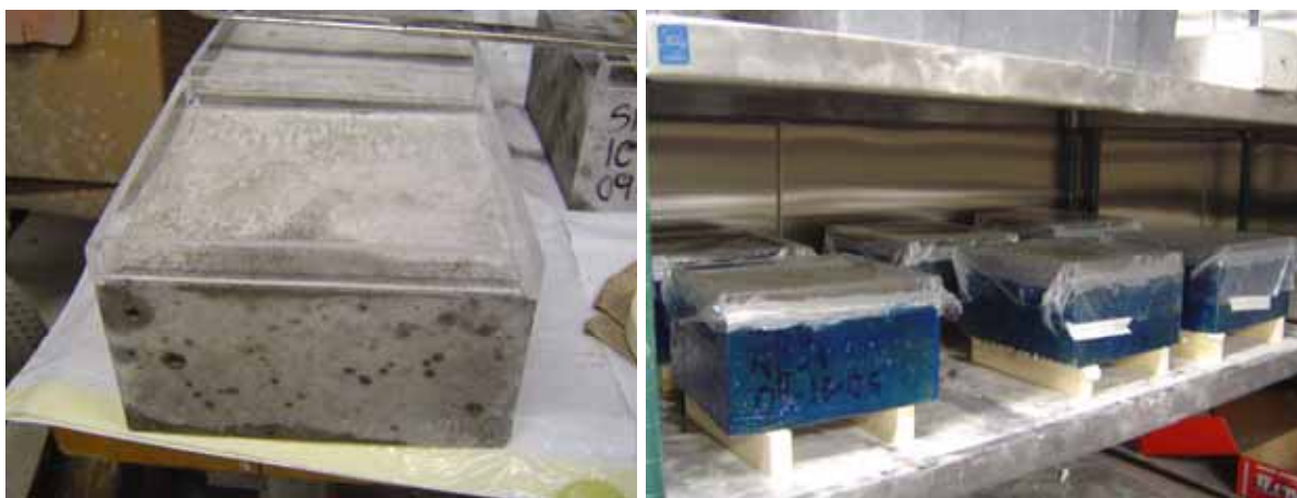
Figura 5.16. Placas de concreto após a limpeza, à esquerda e na câmara climatizada, à direita.
