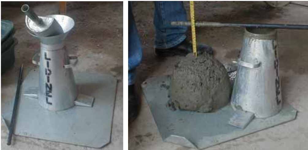
Figura 5.6. Equipamento para determinação do abatimento do tronco de cone, à esquerda e medida do abatimento, à direita.
