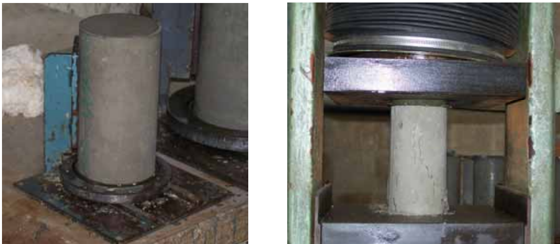
Figura 5.9. Corpo de prova cilíndrico sendo capeado, à esquerda e após o rompimento na prensa, à direita.
