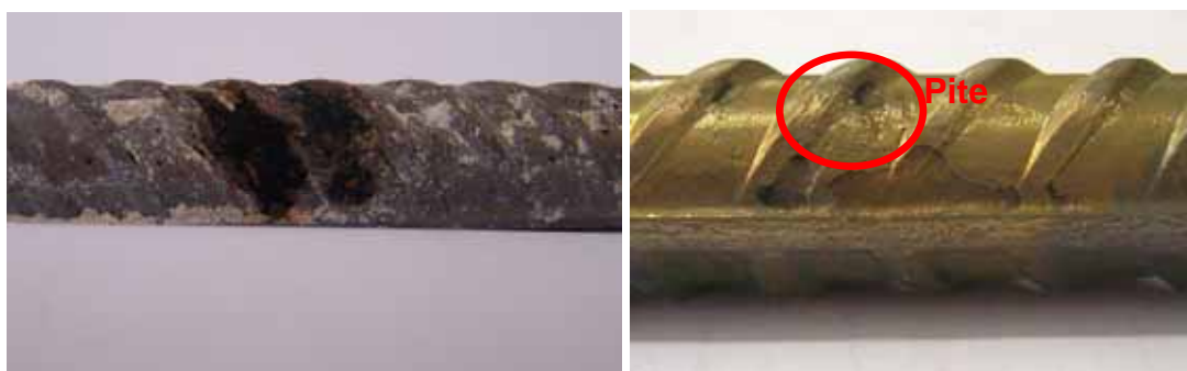
Figura 6.18. Barra apresentando corrosão antes, à esquerda e depois da limpeza, à direita (concreto com IC 1).
