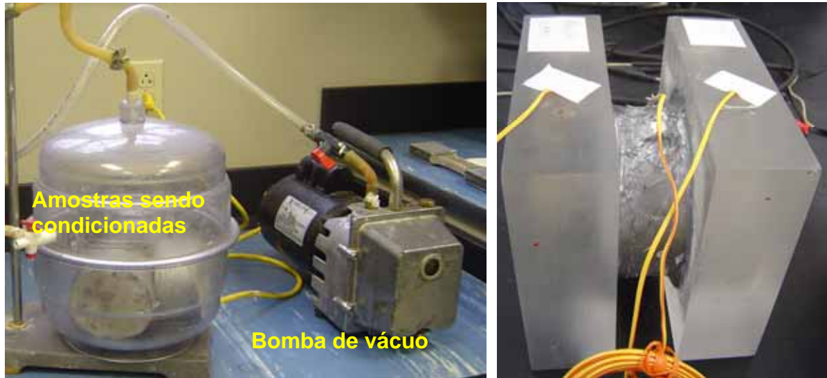
Figura 5.15. Condicionamento dos corpos de prova, à esquerda e célula de ensaio montada, à direita.
