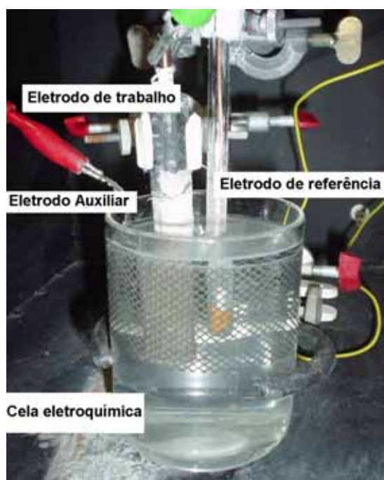
Figura 5.4. Célula eletroquímica.
