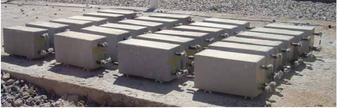
Figura 5.14. Corpos de prova expostos na área industrial da Braskem.
