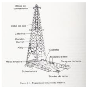
Figura 3.6 – Sistemas de superfície de uma sonda de perfuração: Sustentação (A), Rotativo (B), Circulação (C), Controle (D), Monitoramento (E) e Geração de energia (F).
