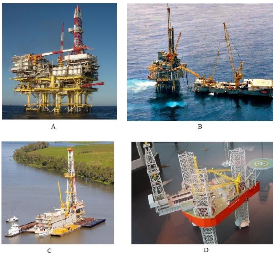
Figura 3.4 – Sondas submarinas Fixas: Plataforma autônoma (A), Plataforma com tender (B), Barcaça (C) e Plataforma Auto-elevável - Jackup (D).
