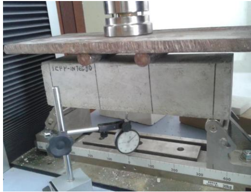
Figura 18- Ilustração do aparato experimental para a realização do ensaio a flexão em quatro pontos com o posicionamento do relógio comparador analógico.
