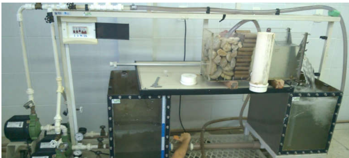
Figura 3. 4: Imagem do circuito utilizado na calibração do vertedor.
