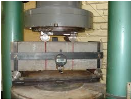
Figura 19 – Ensaio de resistência à tração na flexão – NBR 5738 (moldagem) e NBR 12142 (ensaio)
