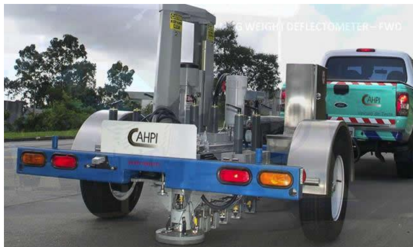
Figura 27 – Teste não destrutivo pelo Falling Weight Deflectometer – FWD
