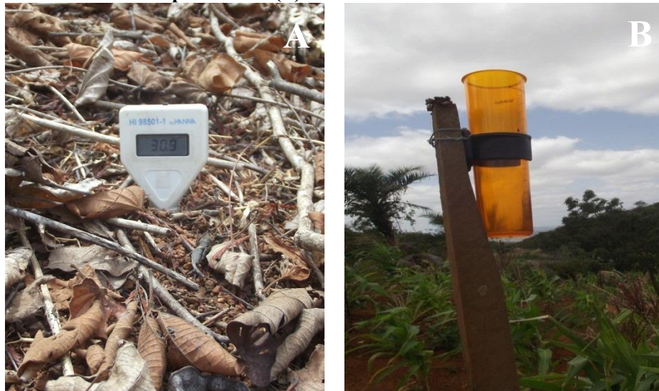
Figura 15-Medição da temperatura do solo (A) e Pluviômetro instalado na área experimental (B).
