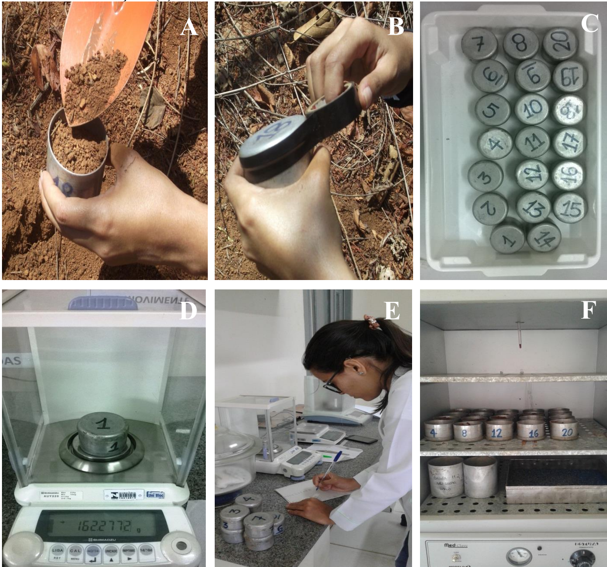
Figura 14-Coleta de amostras de solo em latas alumínio (A), vedação das latas (B), preparação das amostras(C), pesagem da lata e tampa com solo úmido em balança analítica (D) anotação dos valores de pesagem (E), secagem das amostras em estufa de circulação de ar forçada (F).
