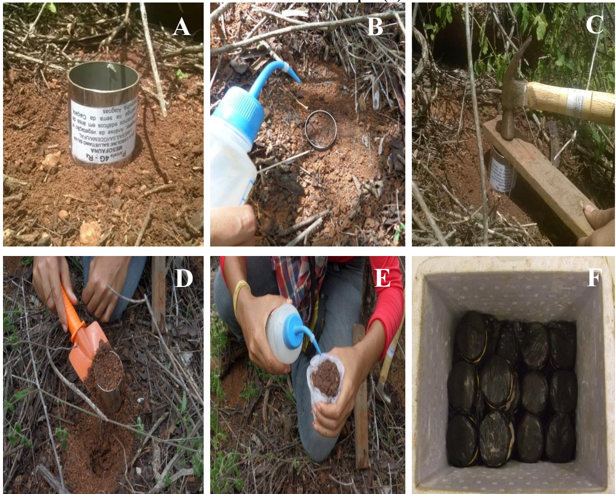
Figura 9-Anel metálico utilizado na extração da mesofauna edáfica (A), umedecimento do solo (B), introdução do anel metálico no solo com auxílio de madeira e martelo (C), remoção com espátula (D), armazenamento da amostra com TNT, tule e liga de borracha (E) e acondicionamento das amostras em caixa de isopor (F).
