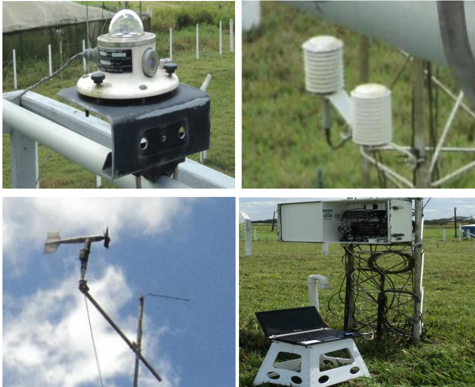
Figura 4 - Instrumentos de medida das variáveis meteorológicas e o datalogger de armazenamento dos dados.
