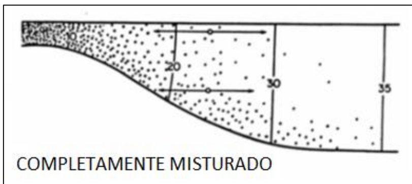
Figura 4: Diagrama esquemático de um estuário do tipo completamente misturado
