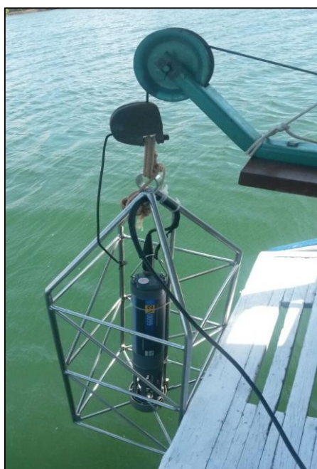
Figura 25: Sonda CTD para amostragem da salinidade e temperatura da água.
