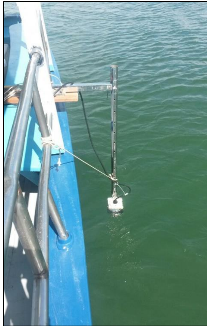
Figura 26: ADCP utilizado para medição da velocidade e direção da corrente.
