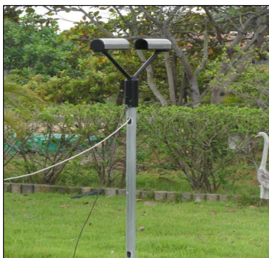
Figura 4.3 Disdrômetro OTT Parsivel 2 localizado na área externa do sistema de radar meteorológico de Alagoas. Fonte: Adaptado de Tayob (2014).
