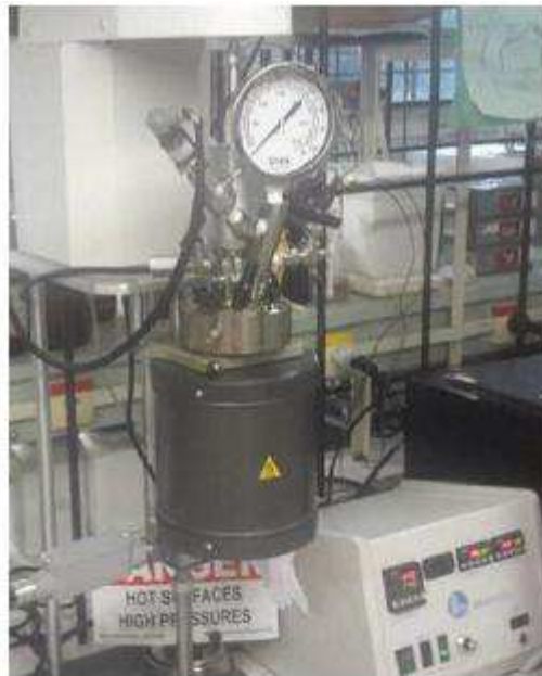
Figura 14. Reator fechado de inox com agitação mecânica.
