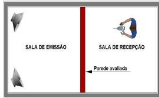
Figura 4- Planta baixa esquemática: Medição de diferença de nível Fonte: Adaptado de Mehta et al. (1999).
