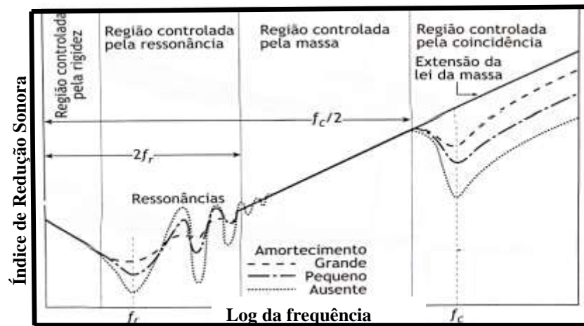
Figura 7- Curva típica do Índice de Redução Sonora para uma parede simples. Fonte: Adaptado de Bistafa (2011).
