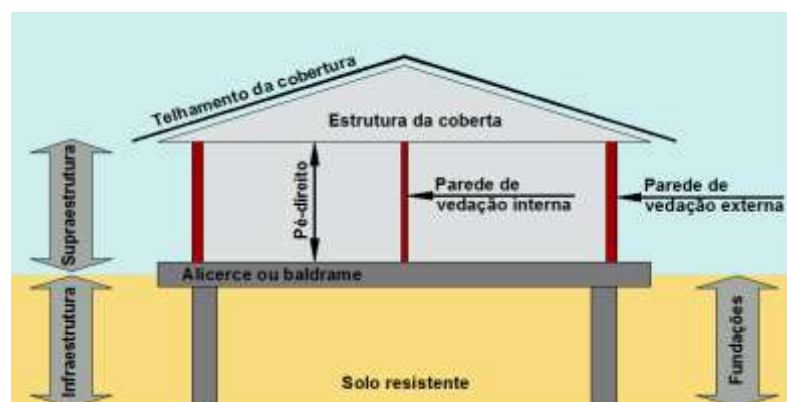
Figura 21- Alvenaria convencional e seus subsistemas. Fonte: Setembro 2015.
