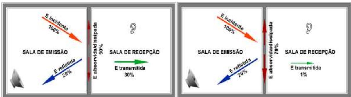
Figura 1- Balanço energético sonoro em uma parede sob incidência de ondas sonoras. Fonte: Adaptado de Long (2006); Mehta et al. (1999).
