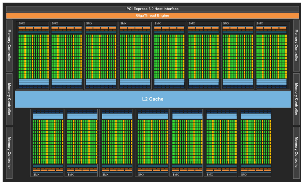
Figura 18: Arquitetura many-core GPU Nvidia Kepler com 2880 núcleos de processamento (ilustrados na cor verde).
