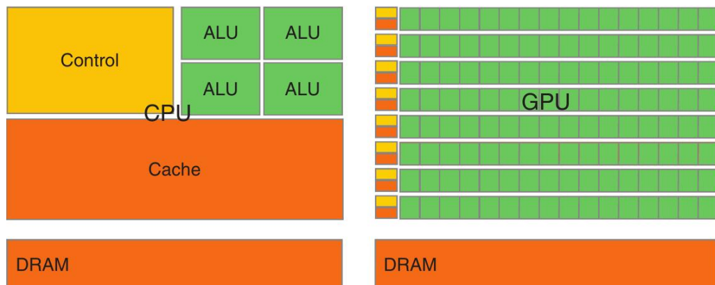
Figura 20: Arquitetura de uma CPU (à esquerda) e uma GPU (à direita).
