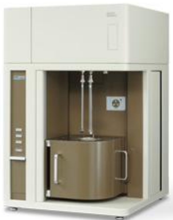
Figura 13: Equipamento de BET – Teoria de adsorção multimolecular
