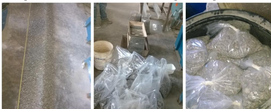
Figura 4: Pilha alongada de base triangular; armazenamento em sacos após obtenção das alíquotas; tonel de armazenamento das alíquotas, respectivamente
