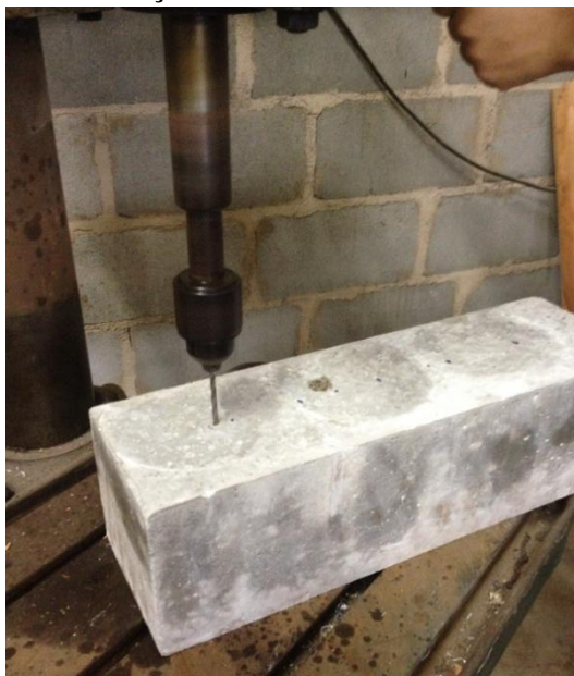
Figura 20: Execução dos furos na furadeira de bancada
