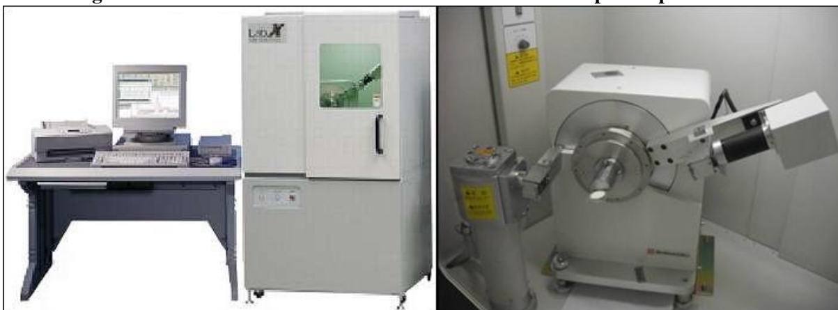
Figura 11: Difratorômetro de raios x e amostrador encaixado pronto para o ensaio
