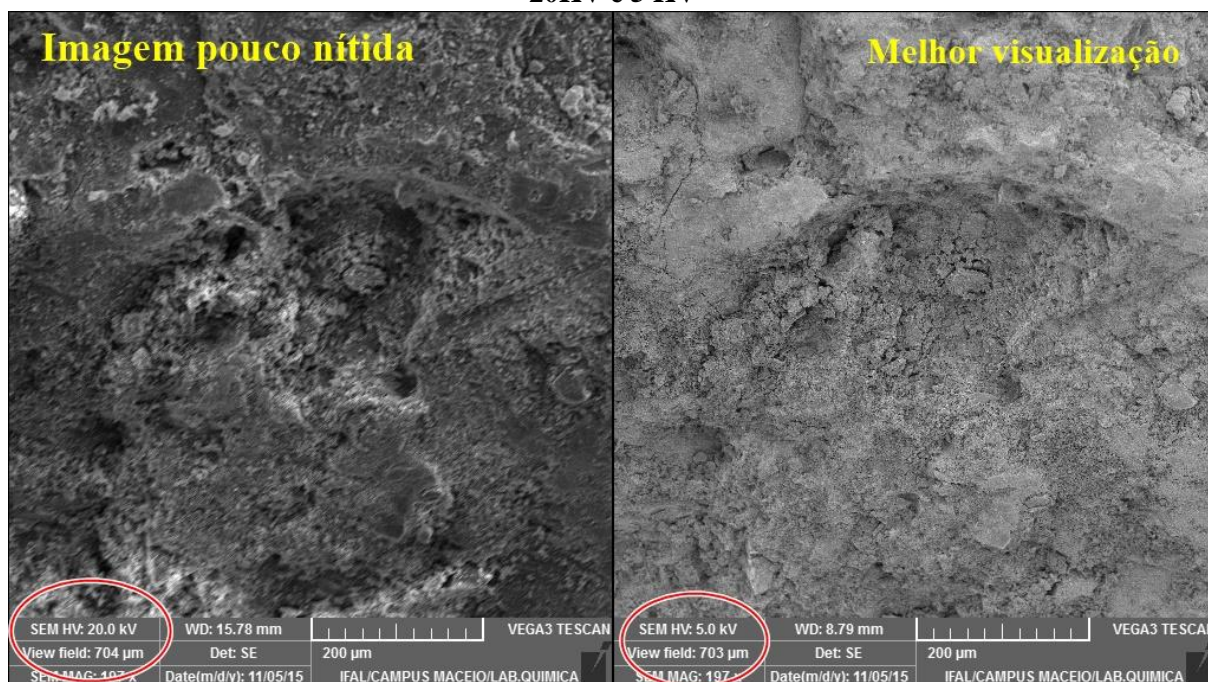
Figura 15: Testes feitos na mesma amostra (ARGC não carbonatado) com energias diferentes: 20KV e 5 KV
