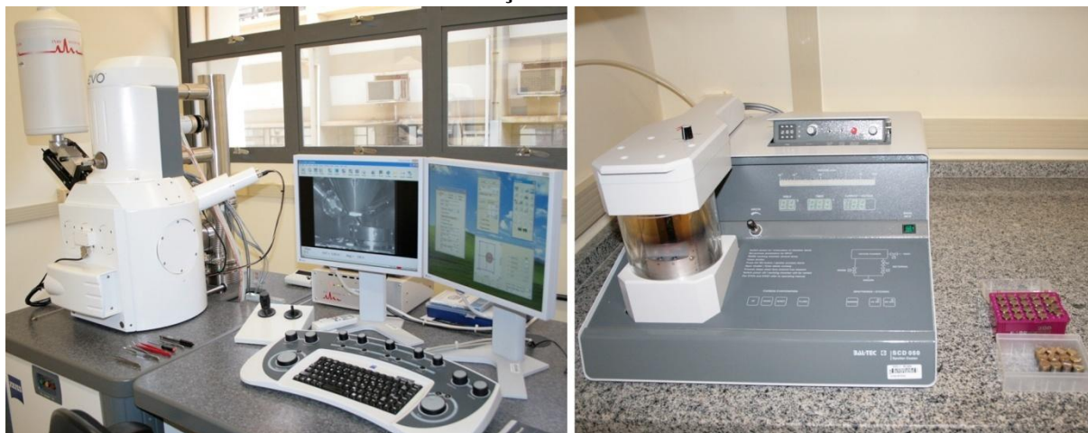
Figura 14: Microscópio eletrônico de varredura e metalizador e evaporador usado na metalização das amostras
