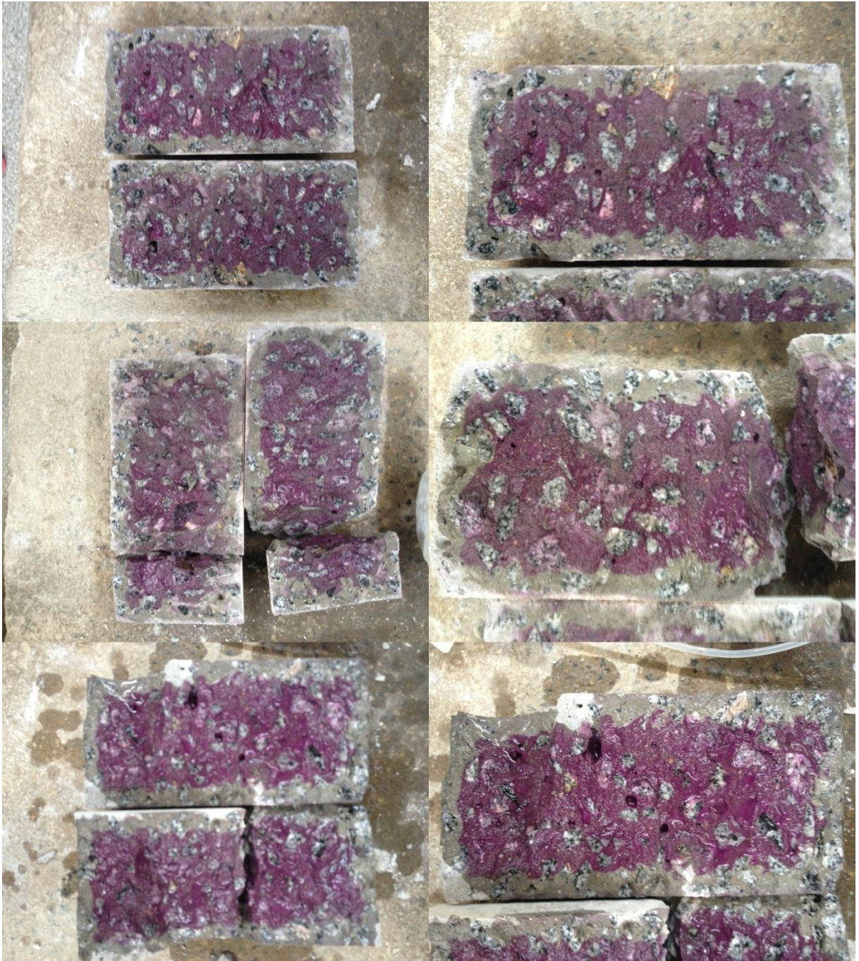
Figura 36: Corpos de prova de CAN ensaiados após aspersão de fenolftaleína para análise de profundidade de carbonatação
