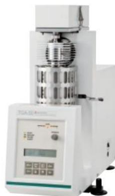
Figura 12: Equipamento de Tg usado nos ensaios de caracterização térmica
