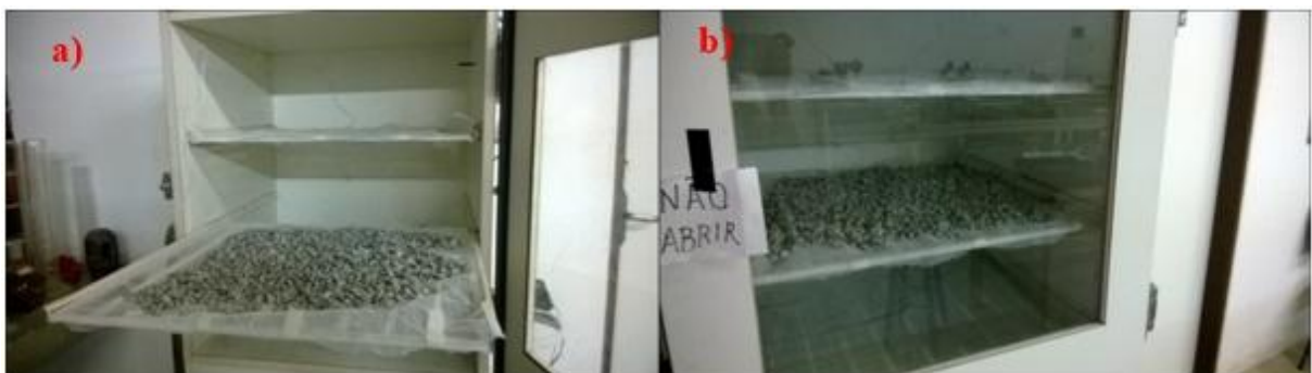
Figura 18: a) Divisão interna de grades metálicas com telas poliméricas e b) câmara fechada e travada
