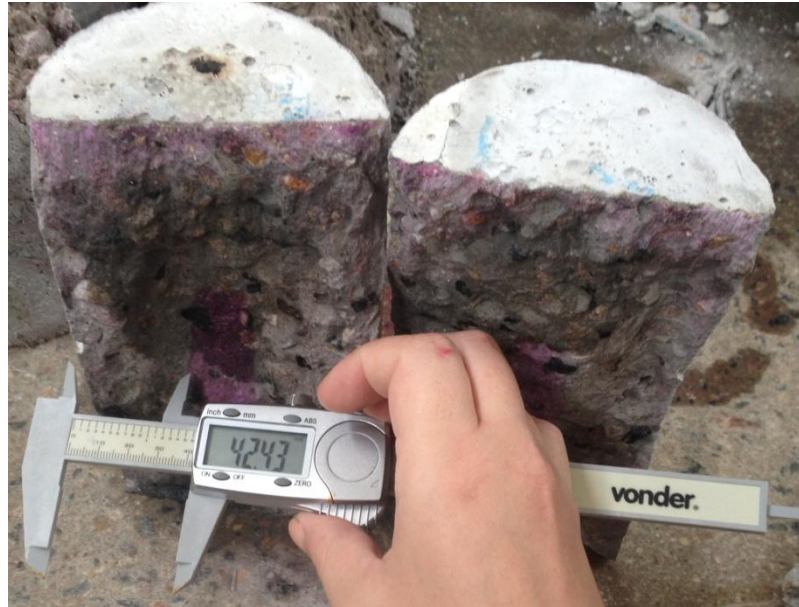
Figura 38: corpo de prova de CARGCNC com reação alcalina central
