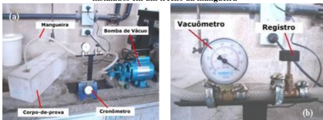
Figura 21: a) Equipamento e esquema do ensaio, b) Detalhe do vacuômetro e do registro, instalados em um trecho da mangueira
