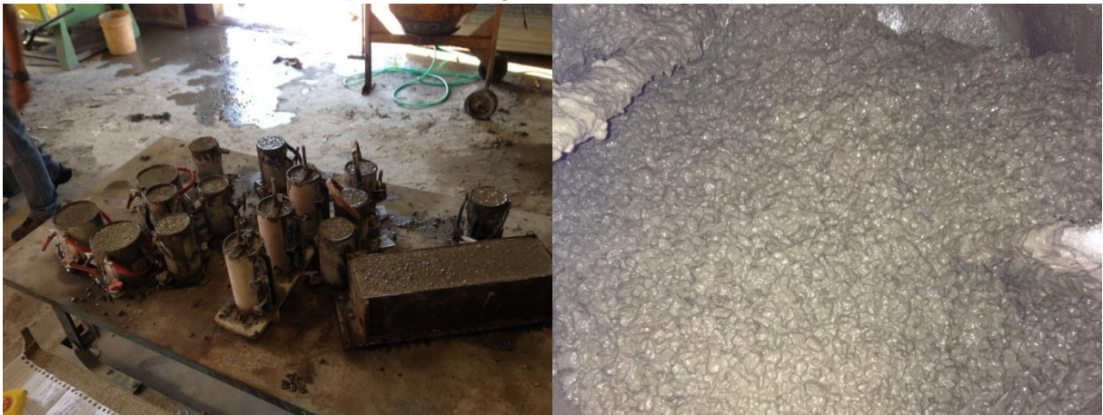
Figura 35: Visualização da consistência do concreto na betoneira e moldagem dos corpos de prova e vibração na mesa vibratória
