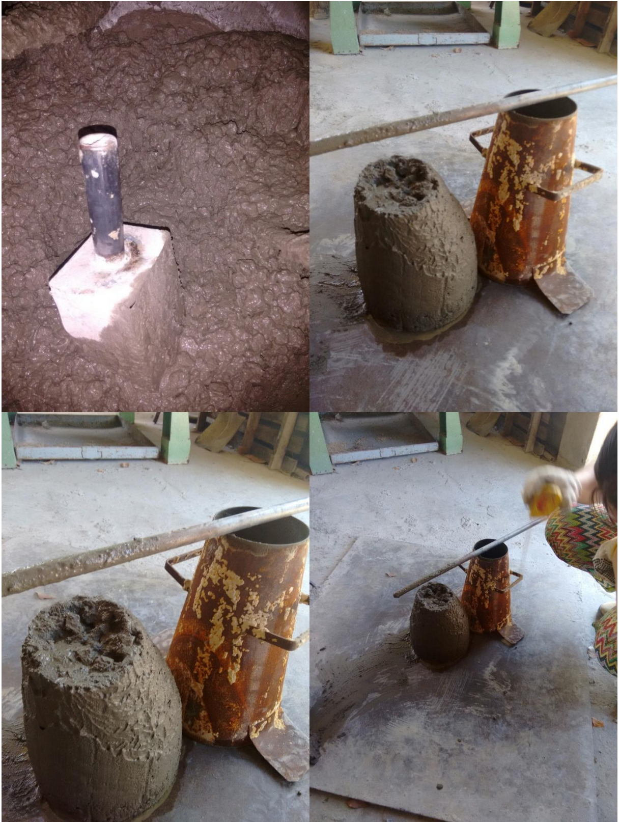
Figura 34: Visualização da consistência do CAN e ensaio de abatimento
