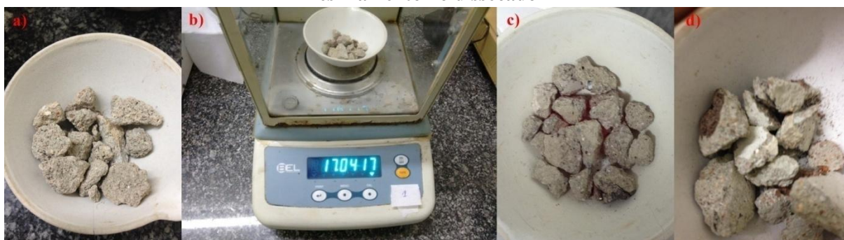
Figura 8: Amostras em quatro momentos respectivos: a) após remoção dos agregados sem argamassa aderida, b) pesagem em balança de precisão, c) após a saída da mufla e d) após o resfriamento no dessecador
