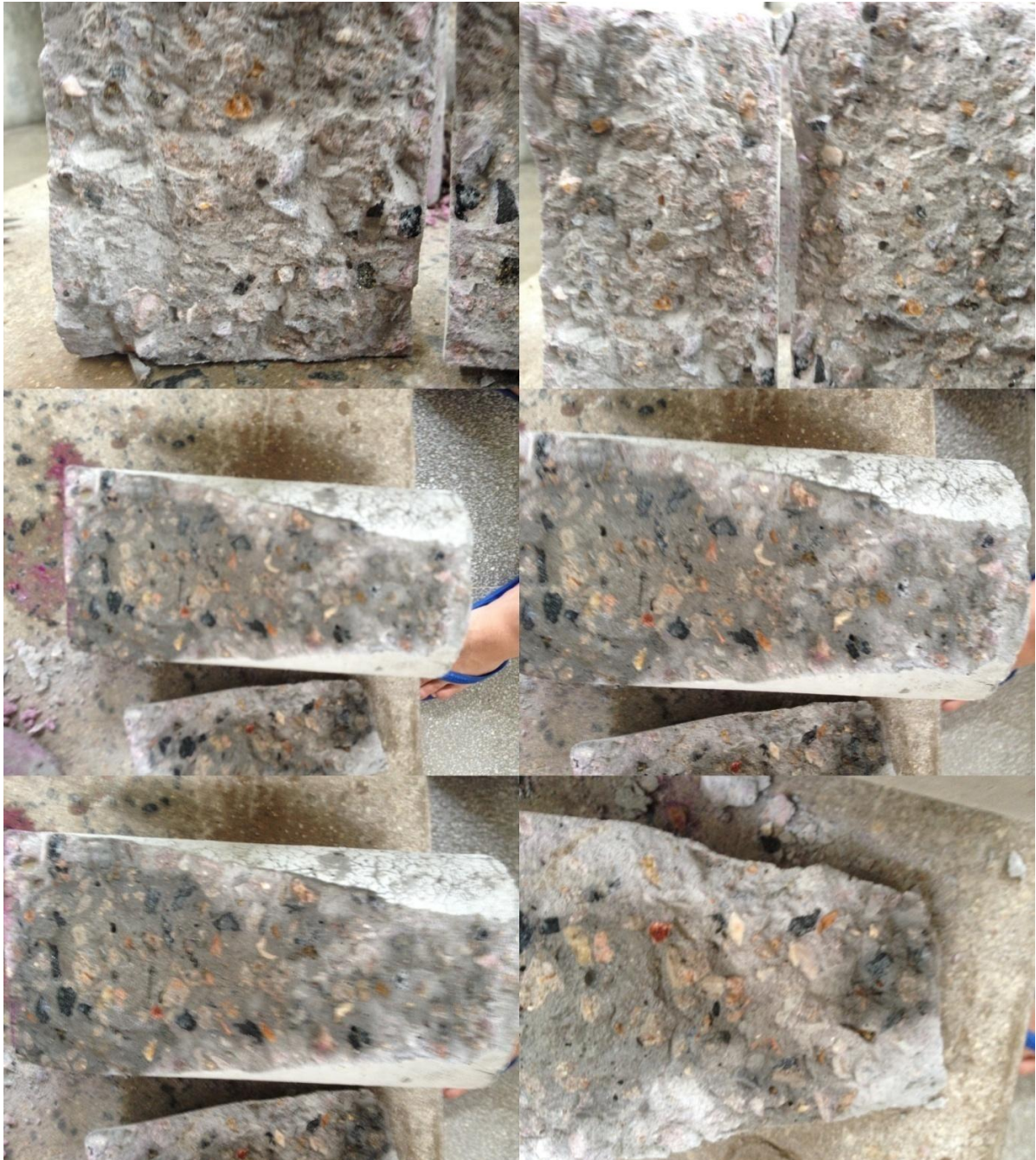
Figura 37: Corpos de prova de CARGCNC ensaiados após aspersão de fenolftaleína para análise de profundidade de carbonatação
