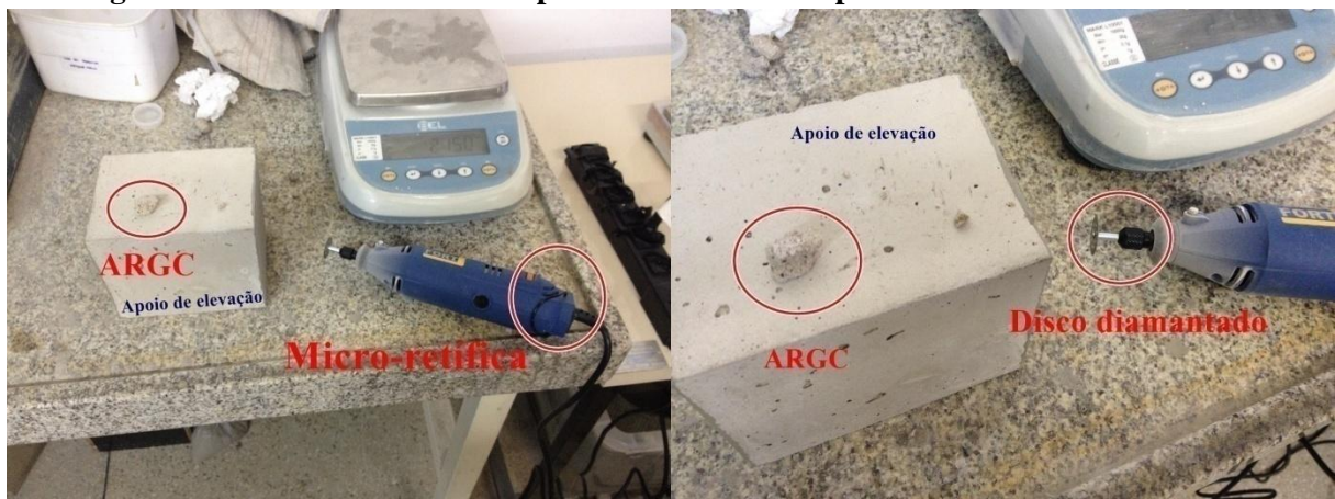
Figura 10: Retirada de amostras para análise microscópica utilizando a micro-retífica
