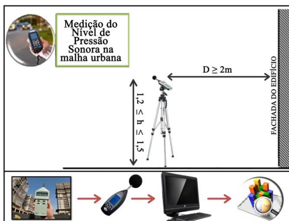
Figura 37 - Distância da medição externa de acordo com a NBR 10.151 (ABNT, 2000)
