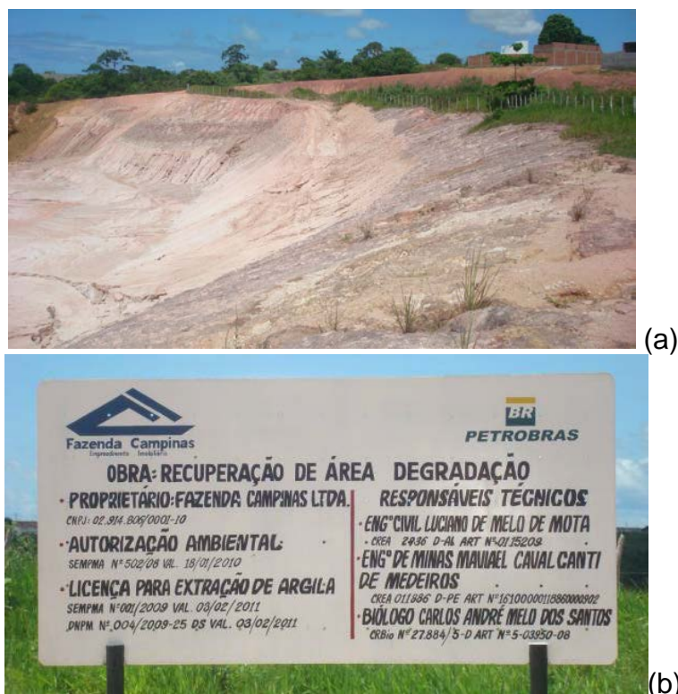
Figura 58 – Ocupação e voçoroca em área de extração de argila em APP com declive acima de 45° na bacia do Jacarecica, no bairro Serraria
