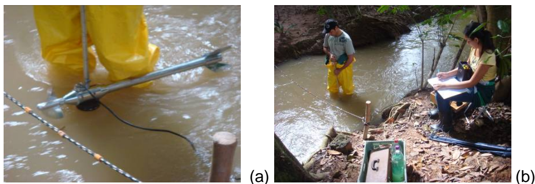
Figura 22 - Medição de Vazão com Molinete Fluviométrico
