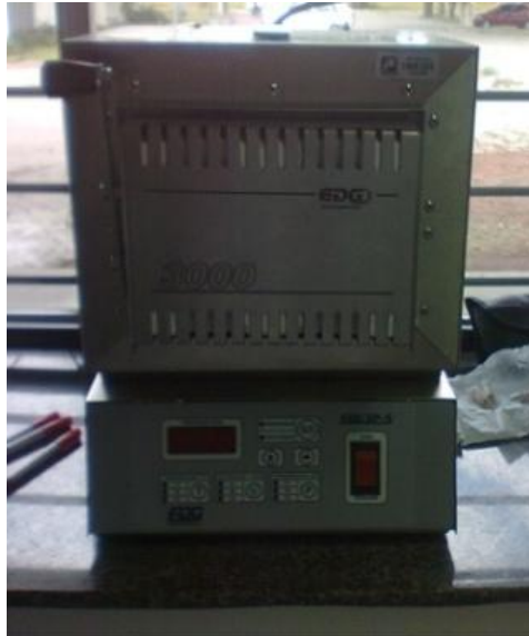
Figura 17 - Mufla utilizada para determinar o teor de cinzas
