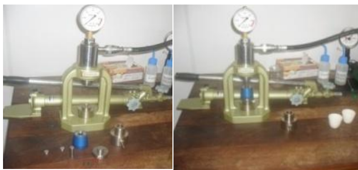
Figura 14 - Sistema utilizado em laboratório para fazer a compactação das amostras.
