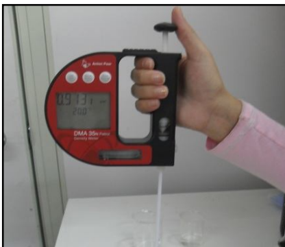
Figura 11 - Densímetro digital utilizado nas análises de densidade.
