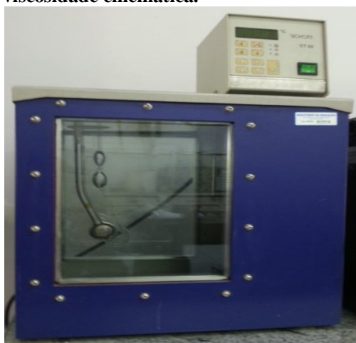
Figura 10 - Viscosímetro e banho termostático utilizados nas análises de viscosidade cinemática.
