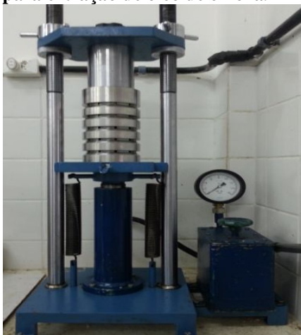
Figura 9 - Prensa hidráulica utilizada para extração de óleo de chichá.
