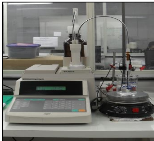
Figura 12 - Titulador automático utilizado na determinação do índice de acidez.
