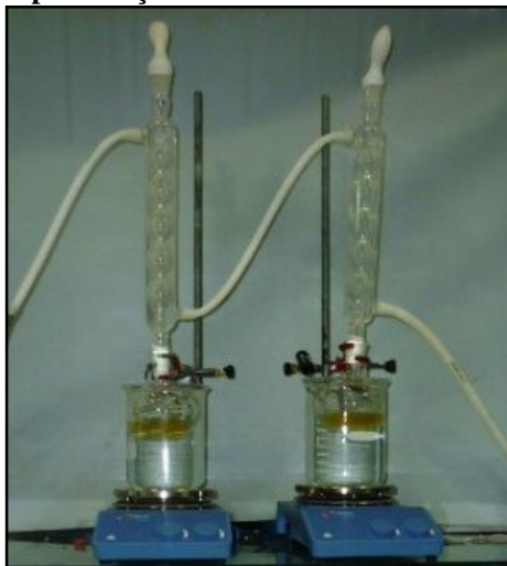
Figura 13 - Sistema reacional sob refluxo para determinação do índice de saponificação.
