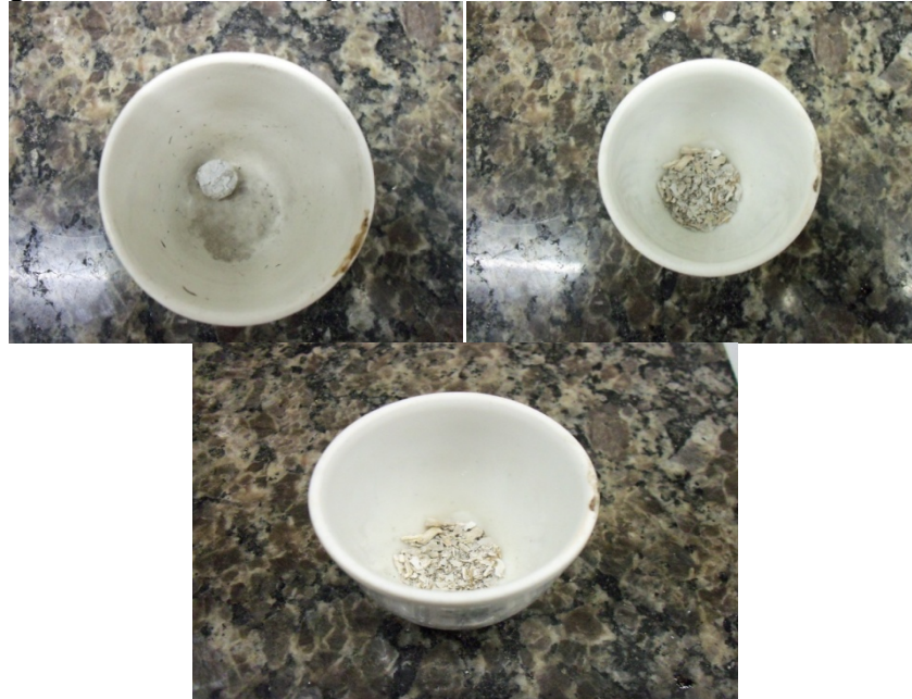
Figura 23 - Amostra depois de fazer a análise do teor de cinzas.
