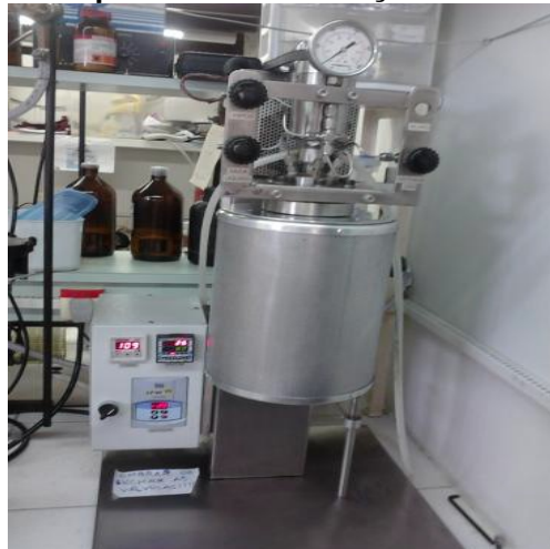
Figura 21 - Reator pressurizado de aço inoxidável (RP)
