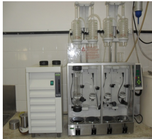
Figura 16(b) - Aparelho de soxhlet para extração do óleo com solvente.
