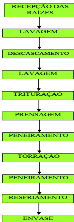
Figura 3 - Fluxograma do processamento da mandioca para produção de farinha
