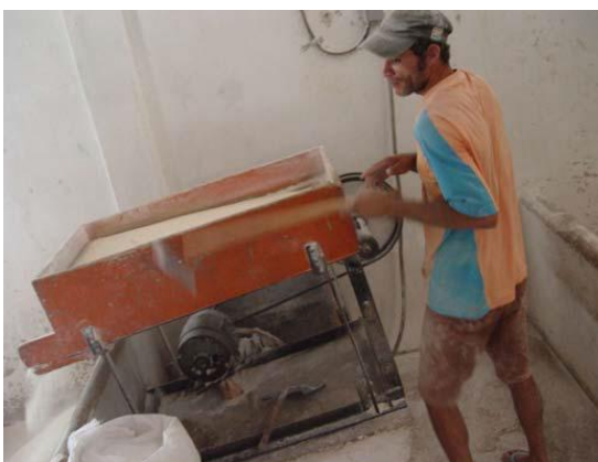
Figura 11 - Peneira de massa prensada em operação
