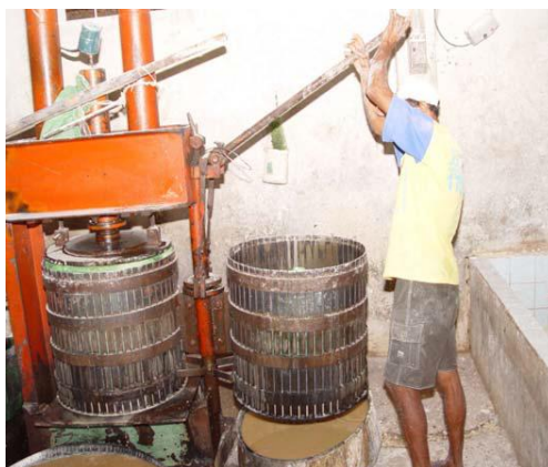
Figura 9 - Prensa hidráulica em operação
