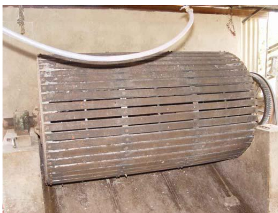
Figura 5 - Equipamento de lavagem e descasque de raízes
