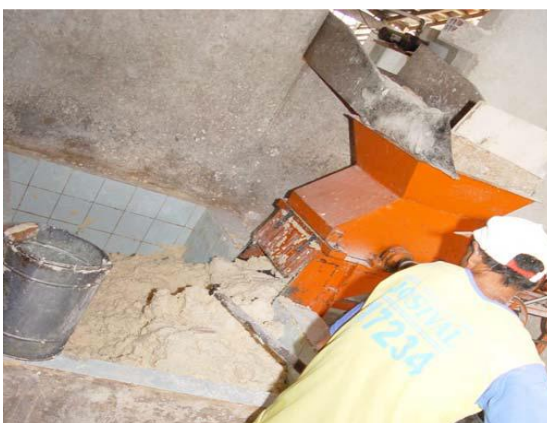
Figura 7 - Triturador de raízes em operação
