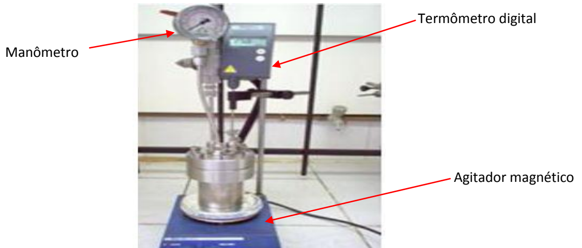
Figura 9 - Reator de aço inox (RP).
