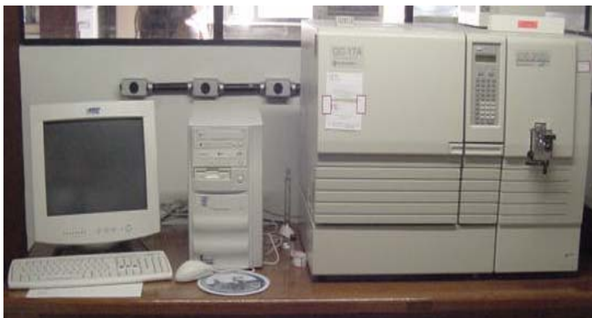
Figura 25. Cromatógrafo Gasoso Acoplado ao Espectrômetro de Massas Utilizado na Identificação dos Ácidos Graxos.
