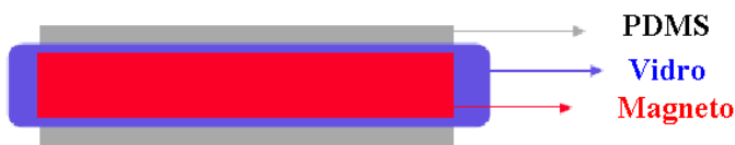
Figura 13: Esquema do revestimento da barra de agitação (SANDRA et al. , 2000)
