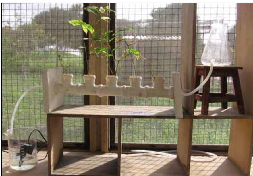
**Figura 2.2. Sistema hidropônico usado nos experimentos**
