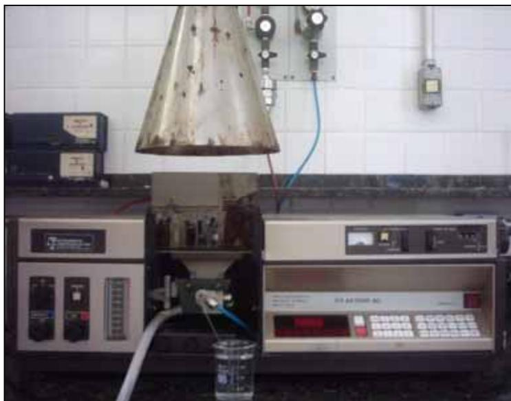
**Figura 2.4.** Espectrofotômetro de absorção atômica usado nas análises
