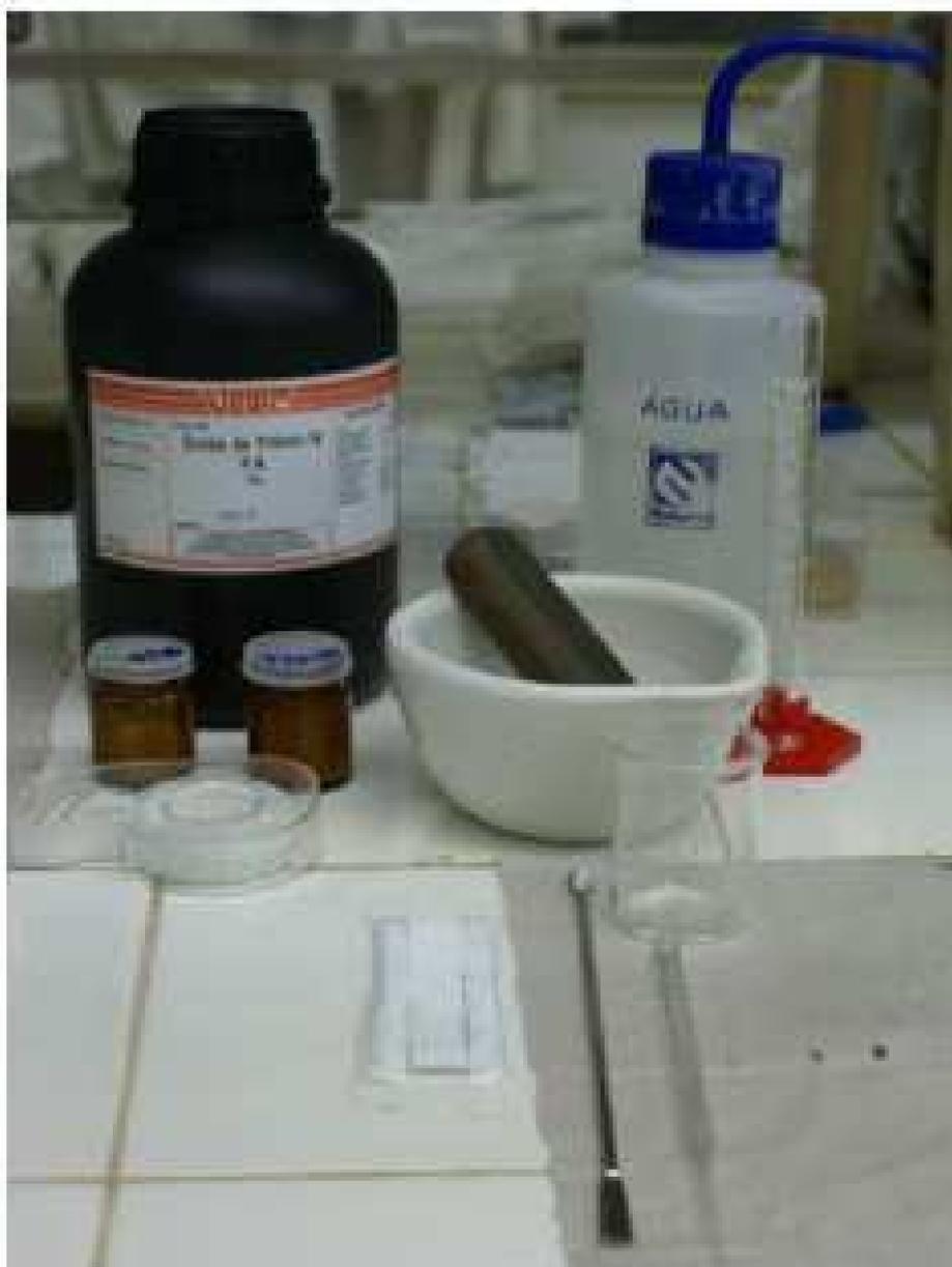
Figura 3.1: Deposição de filme de  $\text{TiO}_2$  sobre vidro condutor de  $\text{SnO}_2\text{:F}$ . Ilustração antes do processo de sinterização.
