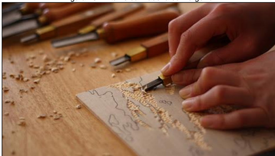
Figura 18: Entalhe da madeira com a goiva.
