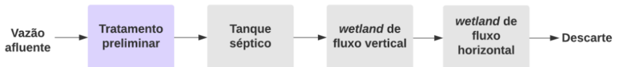
Figura 4: Fluxograma esquemático do sistema de tratamento.
