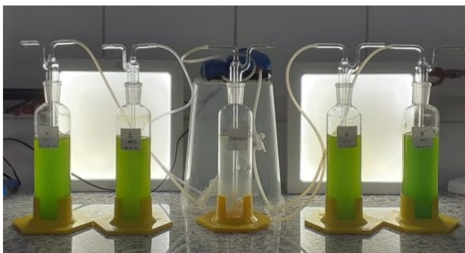
Figura 14 – Configuração 2 do sistema de tratamento utilizado.
