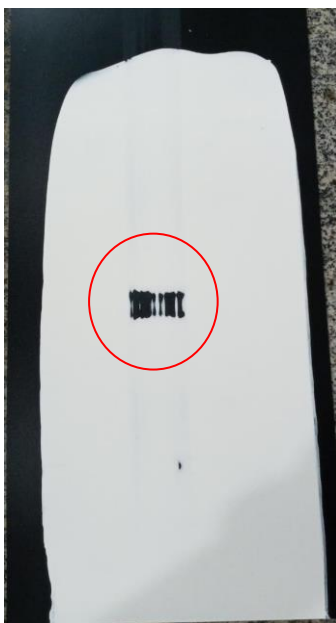
Figura 19: Leneta após teste de resistência a abrasão úmida
