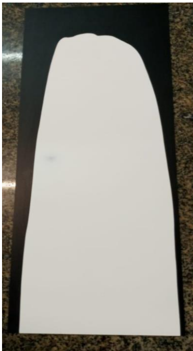
Figura 16: Corpo de prova: leneta com aplicação de uma fina camada de tinta
