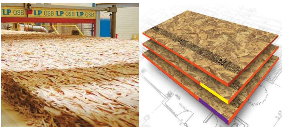
Figura 25 – (a) Fabricação da chapa OSB; (b) Chapa OSB para comercialização
