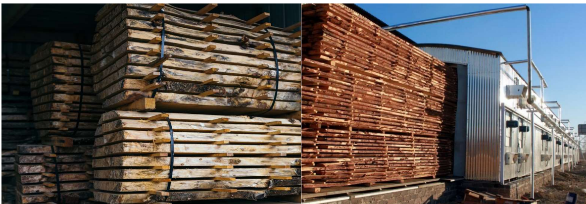
Figura 13 – Secagem da madeira: (a) ao ar livre; (b) em estufa
