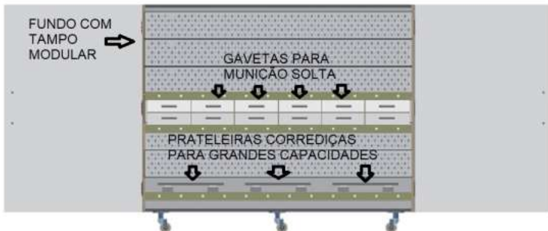
Figura 45: mobiliário para munição com portas abertas
