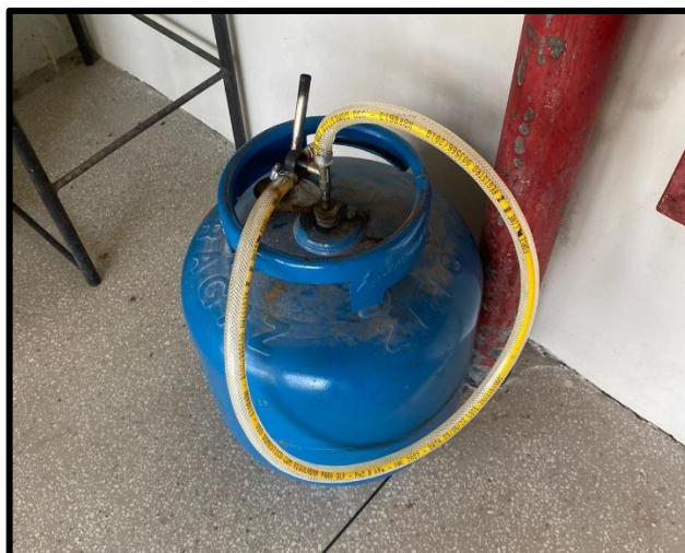
Figura 8 - Bico de Bunsen acoplado diretamente no botijão de gás
