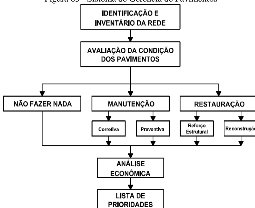
Figura 05 - Sistema de Gerência de Pavimentos
